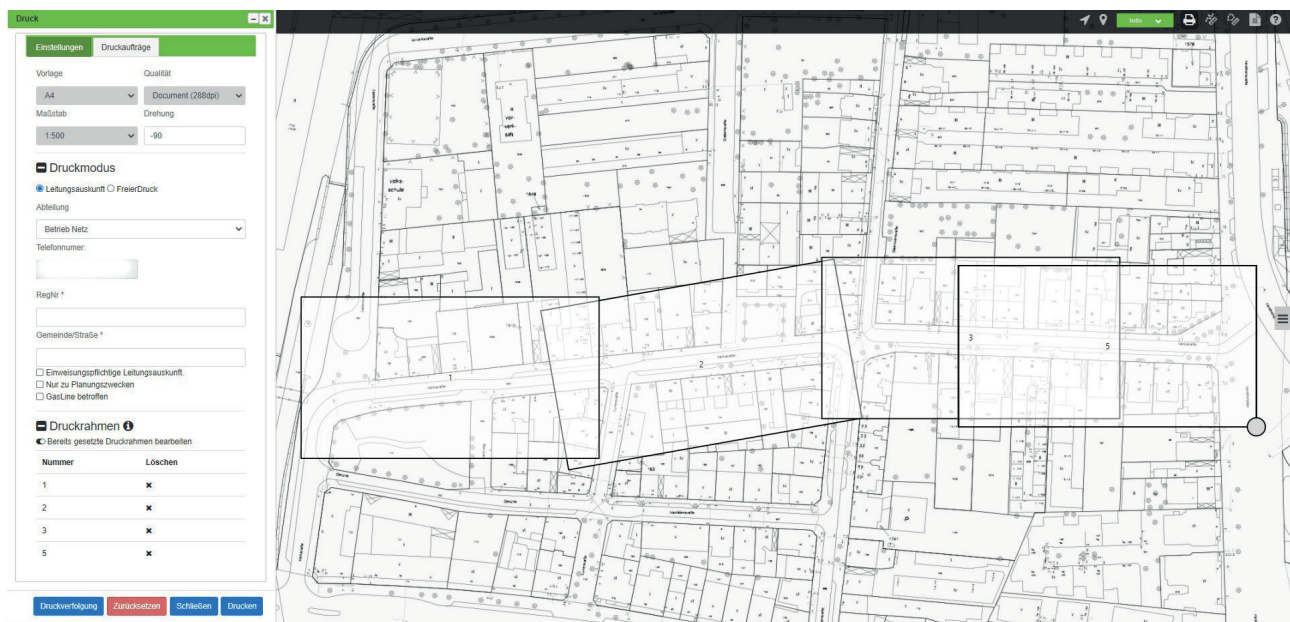
Abb. 1: Platzierung der Druckrahmen entlang eines Straßenzugs mit zugehörigen Einstellungen (Screenshot: Frederik Häfker, WhereGroup)
