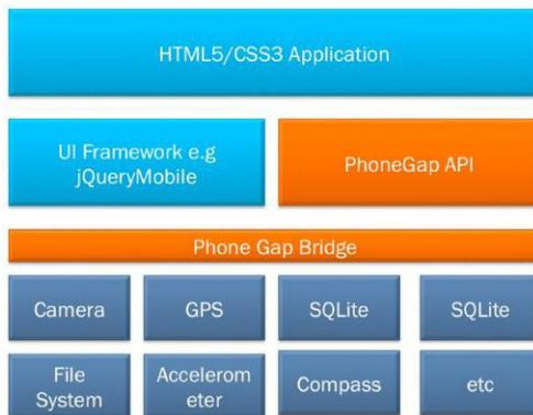
Aufbau einer PhoneGap-Anwendung [1]
